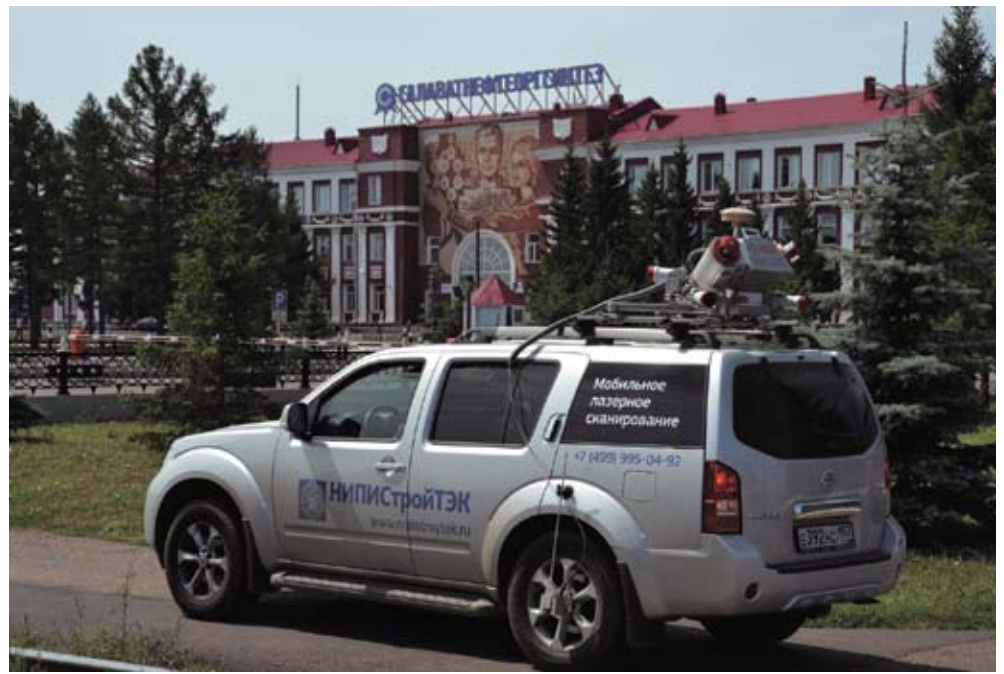
VMX-250, установленная на автомобиле
